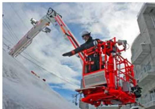
「はしご車=高所」のイメージを覆す下方向への進入操作が可能となり、活動の幅がさらに拡大しています。
