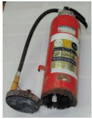
破裂事故をおこした消火器
