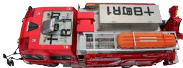
車体上部には、アルミ製縞板で救助用資機材が収納できる取外し可能な大型ボックスを設けている。
