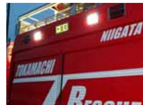
◀車体側面上部に、周囲を有効に照射できるLED作業灯を左右に各2個設け、現場での作業が安全に行える。
