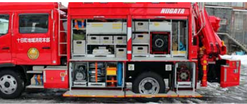
【側面】 オールシャッター式で、下部ステップは展開すると水平になり、資機材が取り出しやすくなっている
