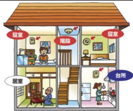
※「煙式感知器」寝室、階段に設置 「熱式感知器」台所などに設置
