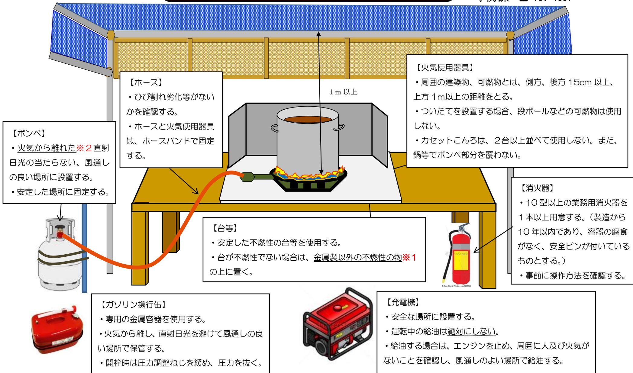
※1 難燃材料以上のもので、台に熱が直接伝わらない範囲の大きさとする。(例：7mm 以上の厚さのせっこうボード、コンクリートブロック等)
