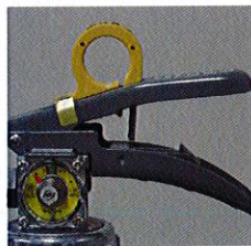
× レバー支えの脱落
