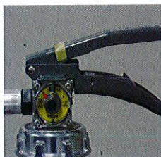
× 安全栓の脱落
