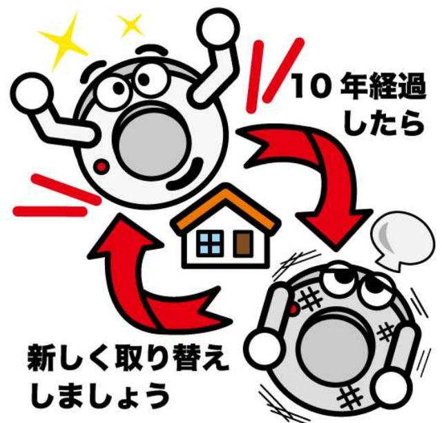
※住警器は精密機械です。長期間の使用は、内部のセンサーが劣化して煙や熱に反応しなくなる恐れがあります。電池の取替えではなく、10年経過したら本体ごと交換しましょう。
